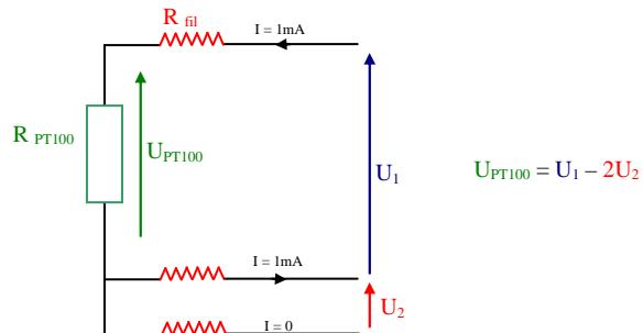
La sonde PT100 est reliée à la carte Arduino UNO via un amplificateur MAX 31865 qui convertit le rapport de la résistance de la PT100 à une résistance référence (ici 430 ohm +/- 0,1 %). Les données sont transmises par une liaison SPI (*Serial Peripheral Interface*). La résistance des fils est compensée.
